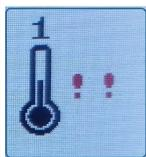
Systém je vybaven nezávislou teplotní pojistikou odpojující oba přívody (z FV panelů i síťový) v obou pólech. Pojistka se aktivuje po překročení teploty 92°C a tento stav je signalizován dvěma červenými vykřičníky v základním menu u ikony BOILER (viz obrázek).
