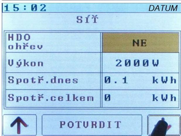
Změnou "HDO ohřev" na "ANO" se aktivuje změna tarifu, při kterém je možno bojler ohřívat energií ze sítě. Šipkami nahoru nebo dolů se provádí změna, tlačítkem POTVRDIT potvrzení.
