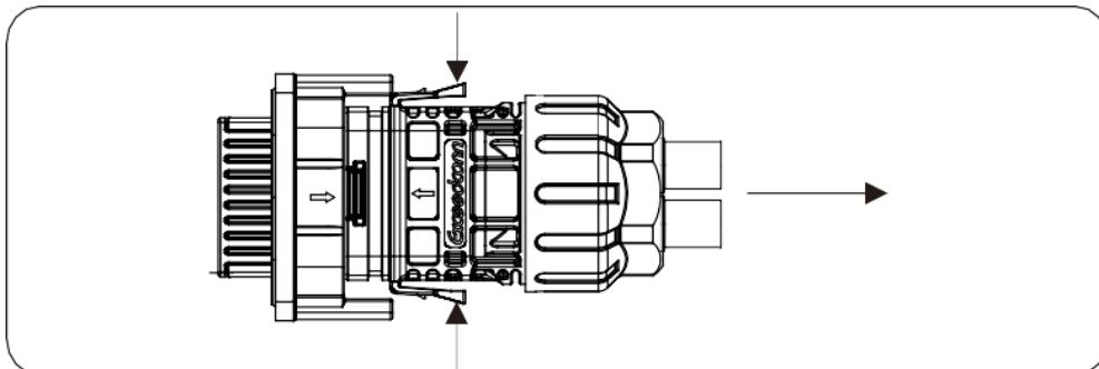
Pro odpojení komunikačního kabelu stiskněte obě západky pro odemčení konektoru a kabel odpojte.
