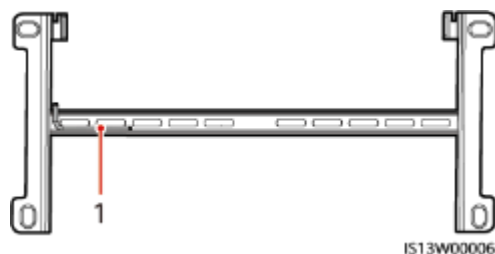
Obrázek 4-9 Poloha pro zavěšení bezpečnostního klíče Torx
