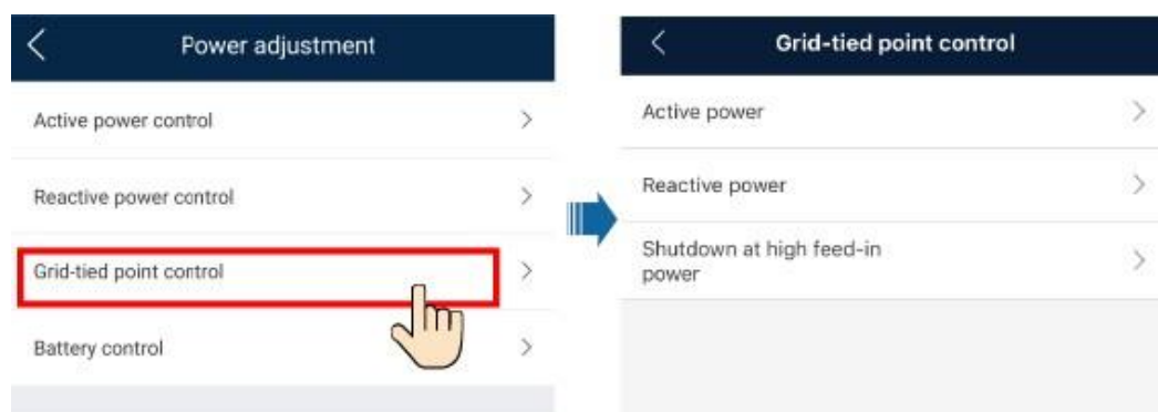
Rysunek 7-5 Sterowanie mocą w punkcie przyłączenia do sieci
