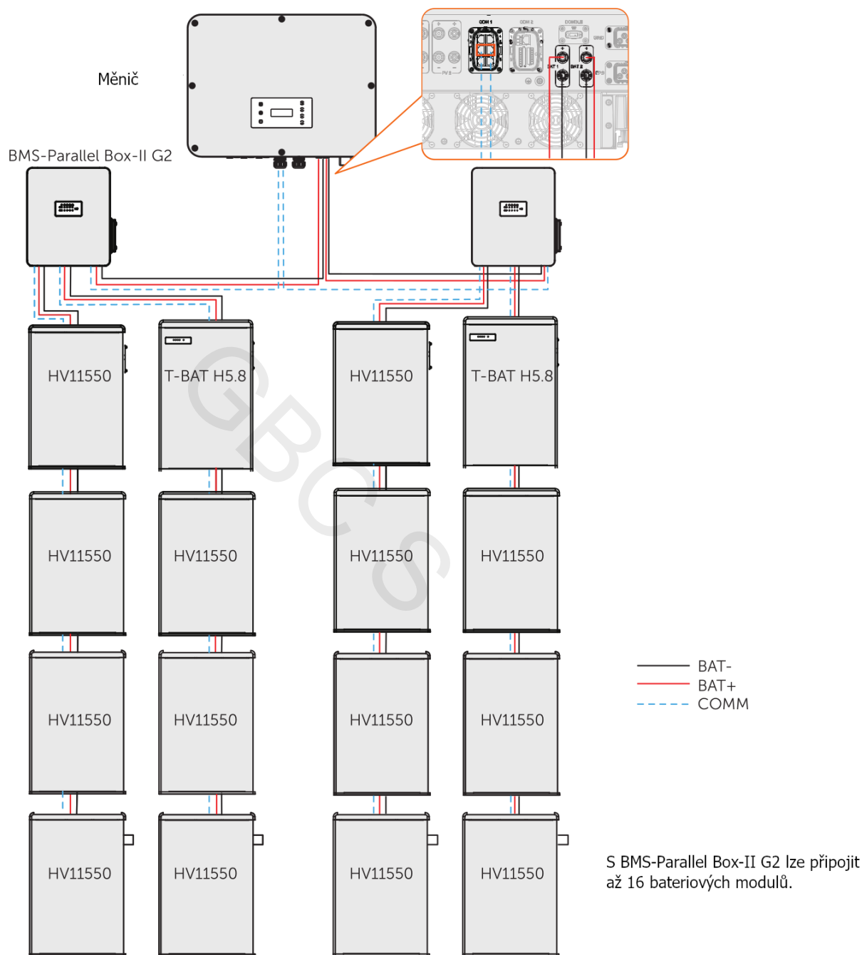
Připojení baterie s BMS-Parallel Box-II G2
