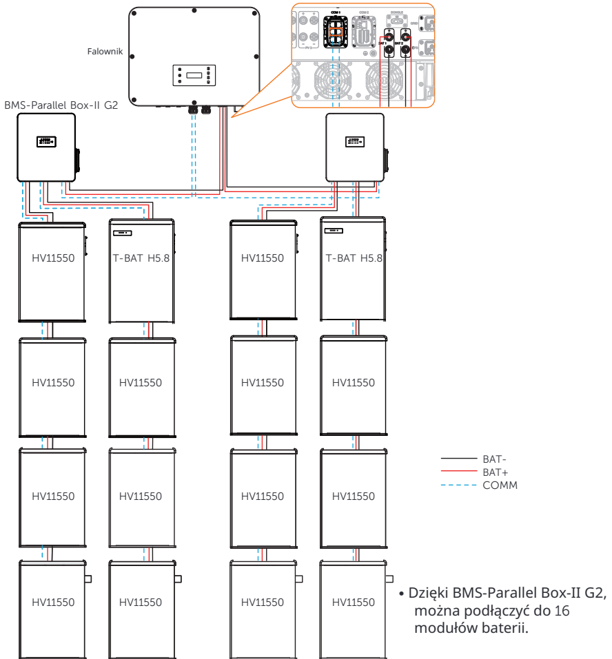
Rysunek 8-26 Połączenie baterii z BMS-Parallel Box-II G2
